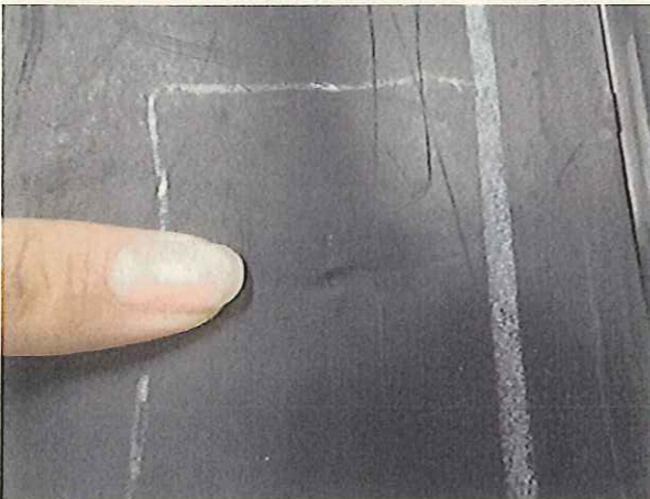
異常検知した現物遮水シートの変形（くぼみ）
