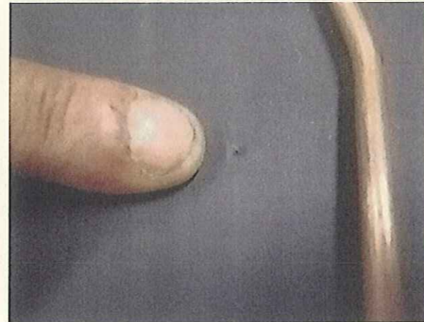
荷重実験により発生した変形（くぼみ）
