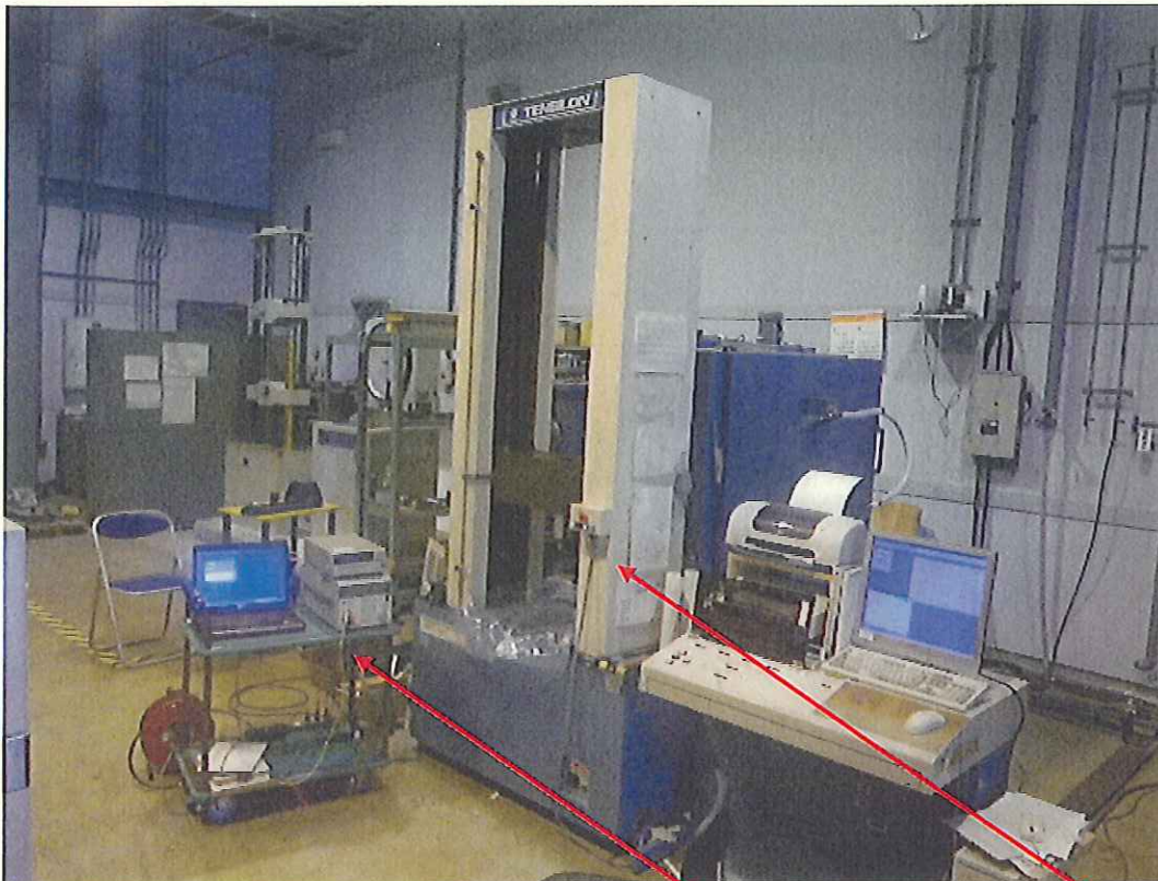
加重通電実験装置全景
