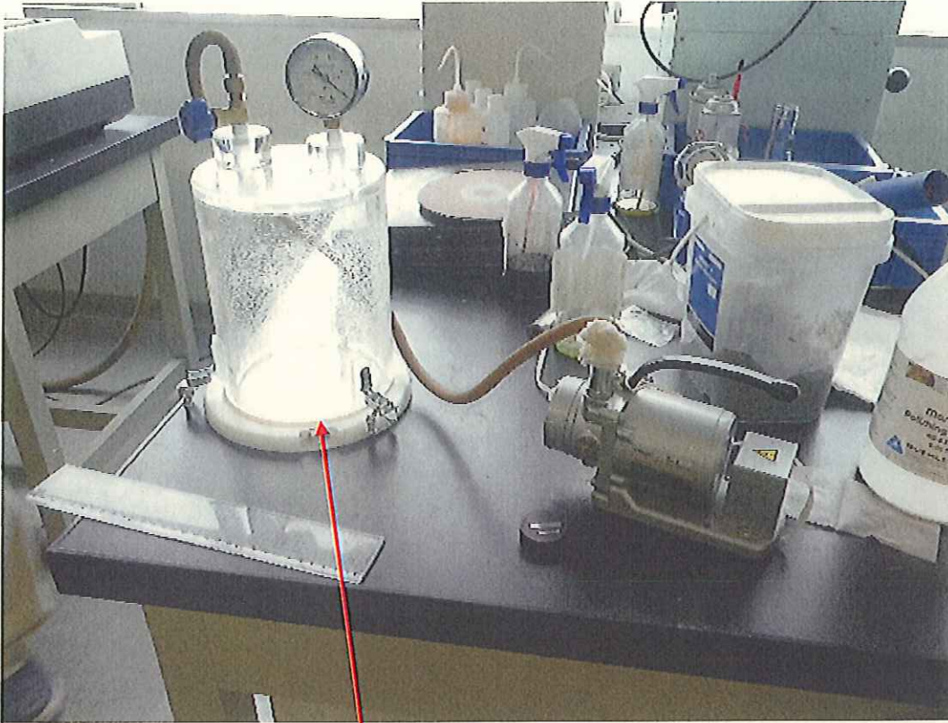
7 前葉の遮水シートを真空デシケーターを使用して負圧試験
