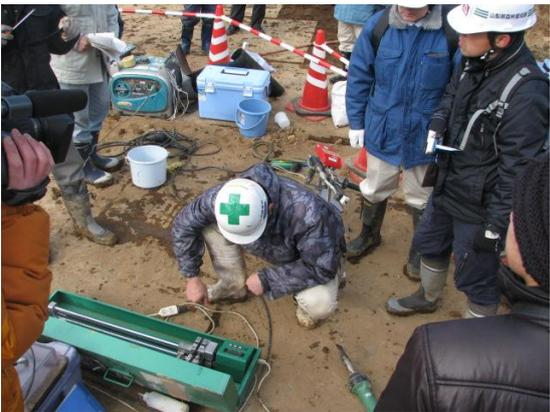
《溶着部分の剪断強度試験状況②》
