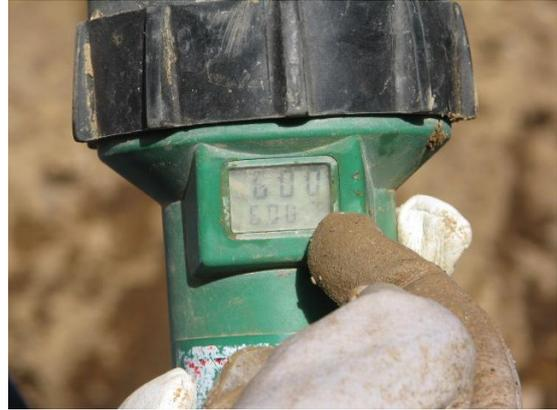
《変形箇所溶着後の負圧試験状況①》
