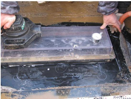
《変形箇所溶着後の負圧試験状況②》
