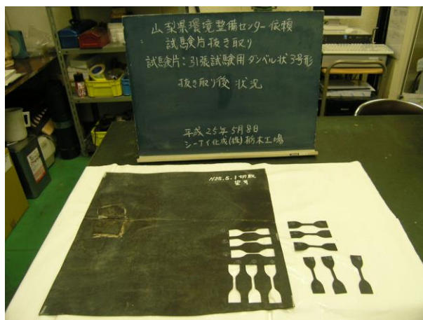
写真7 遮水シートより切り取られた試験片
