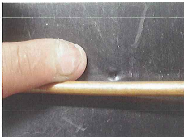
写真 15 重機による圧縮試験によって生じたくぼみ
