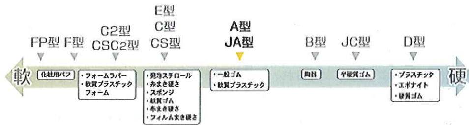
図5 試験材料とデュロメータの型式の簡易的な関係
