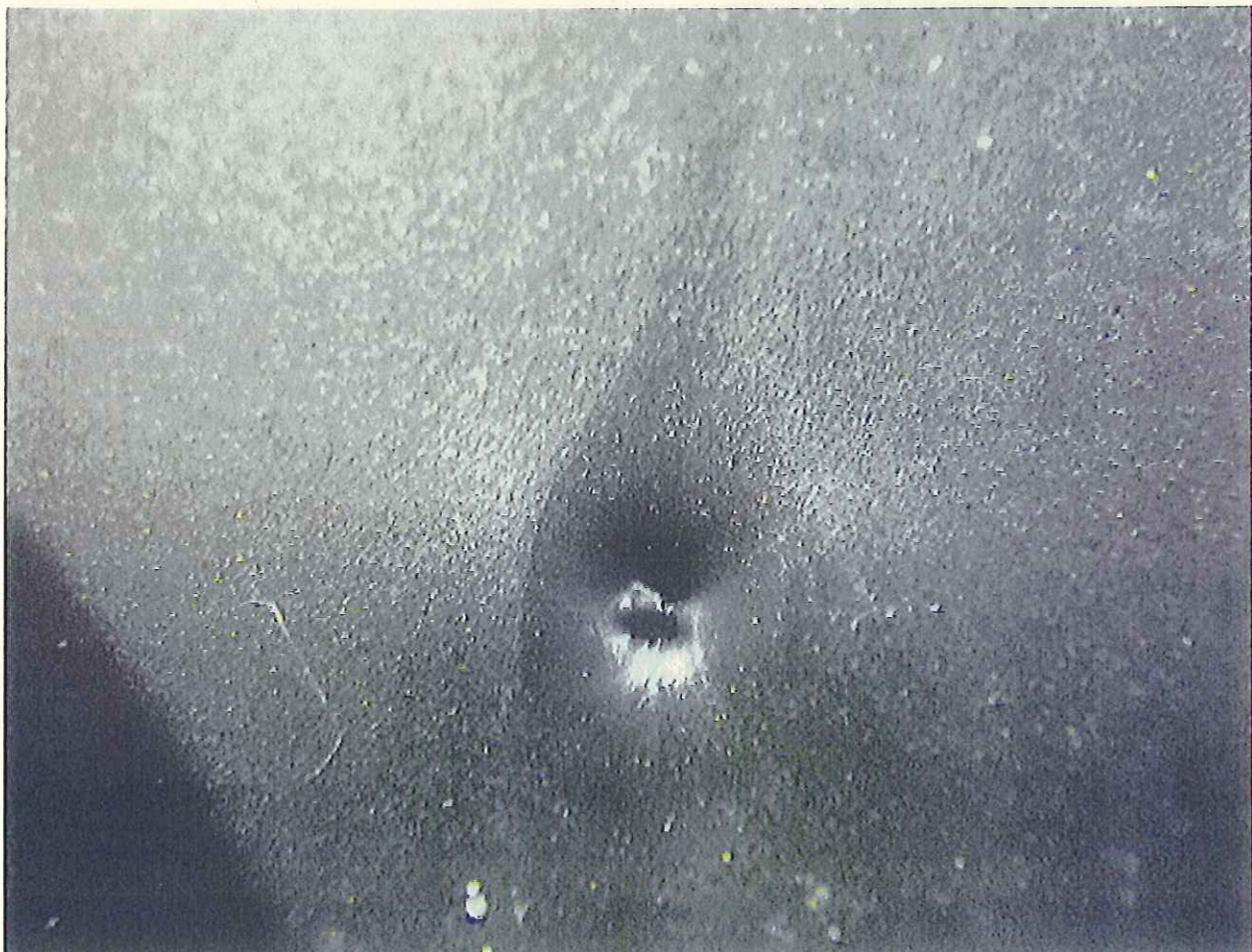
写真—6 基礎実験(事業団) 通電した遮水シートに生じた銅線電極交点部分の圧迫跡
