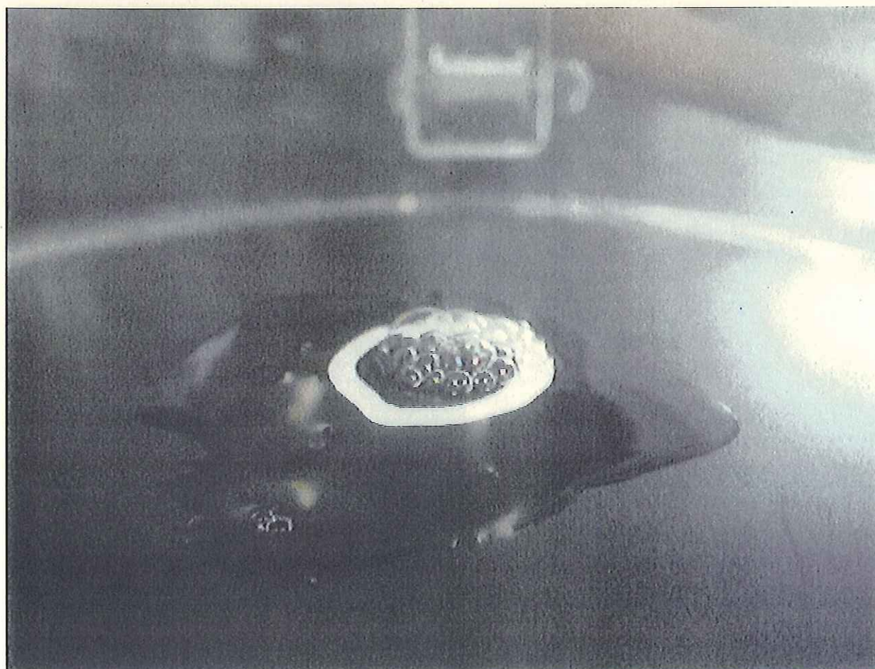
写真-38 実証実験(2日目) 加重面積小で通電ありの2回目では-1kPa未満~-12kPaで気泡発生
