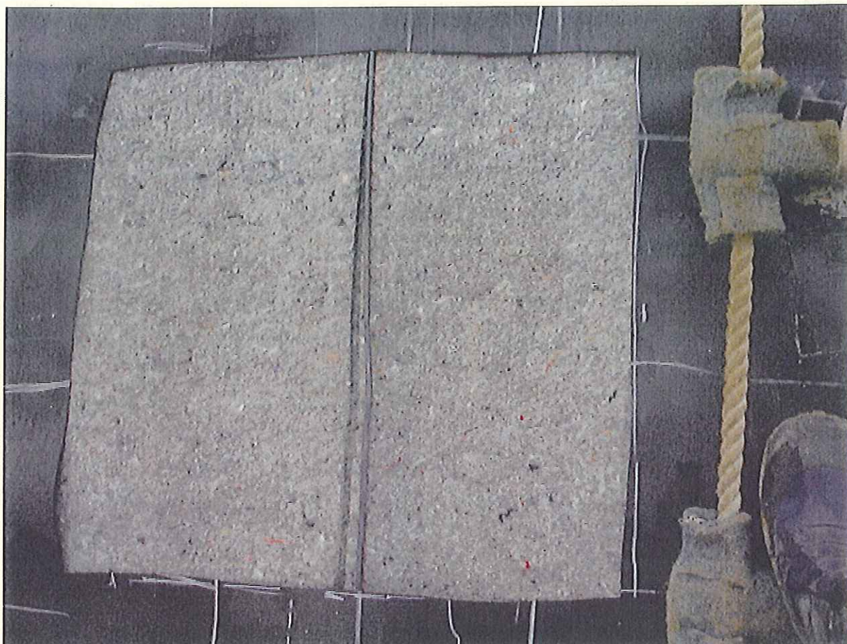
写真-20 埋立地 ③切り取り部の下層確認の状況(銅線電極交点部のアップ) 異常なし
