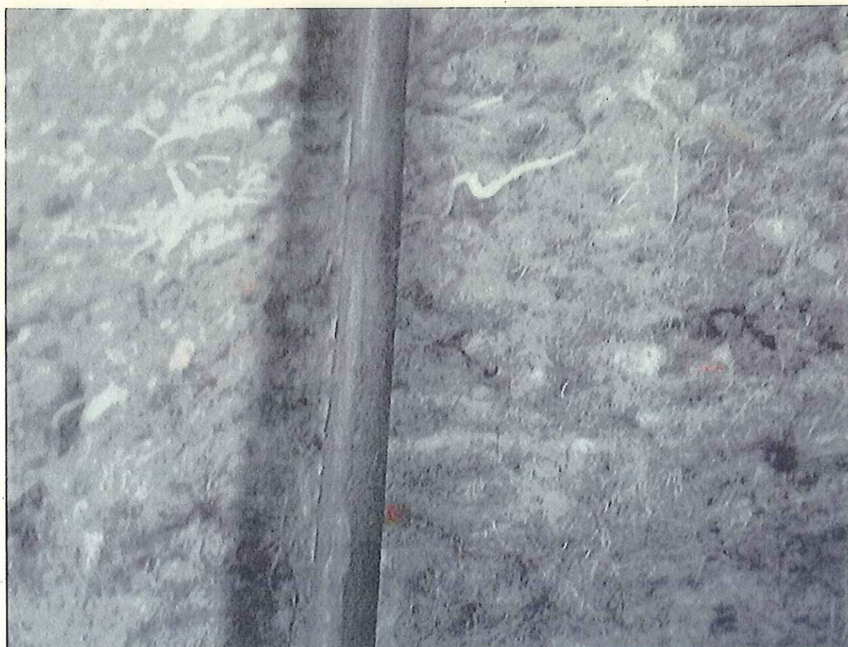
写真-20 埋立地 ③切り取り部の下層確認の状況(銅線電極交点部のアップ) 異常なし
