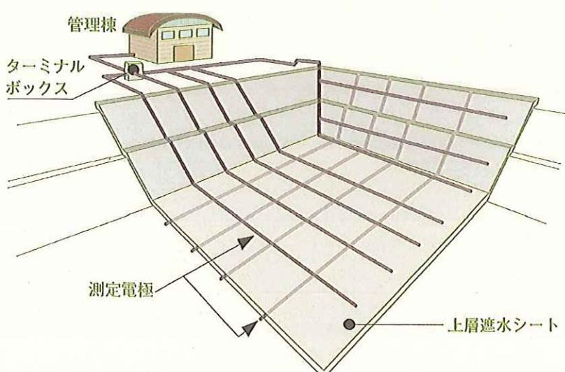
●電気的漏水検知システムは、上層遮水シートをはさんで格子状に配置された測定電極を用いて、上下電極間に流れる電流値を測定し、漏水の有無を検知、位置を特定するシステムです。
