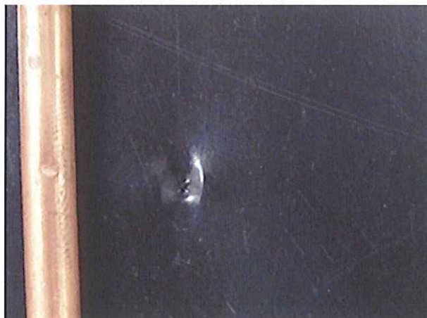
(c) 集中荷重により生じたくぼみ
