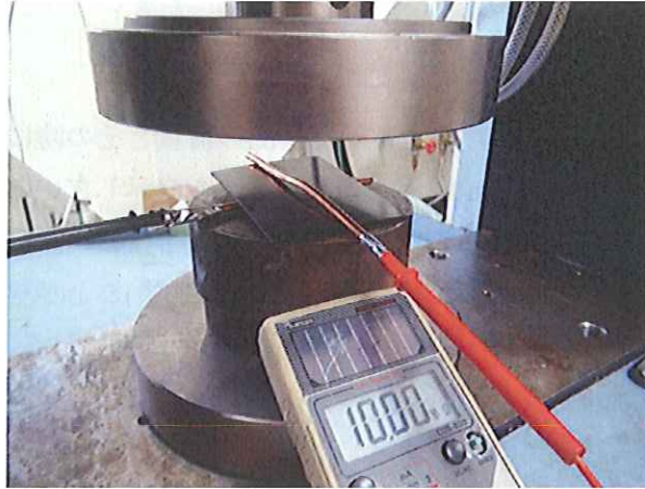
(a) くぼみ発生試験の試験風景
