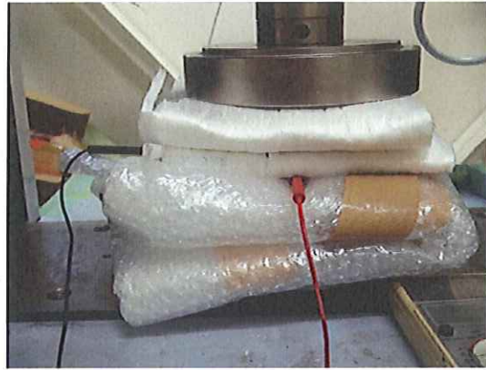
(a) くぼみ発生試験の試験風景
