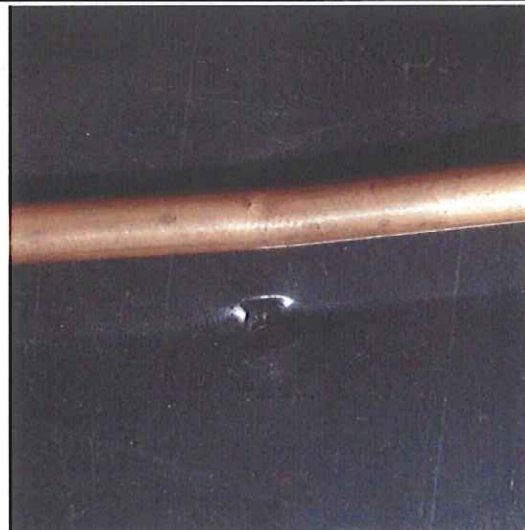
(c) 集中荷重により生じたくぼみ
