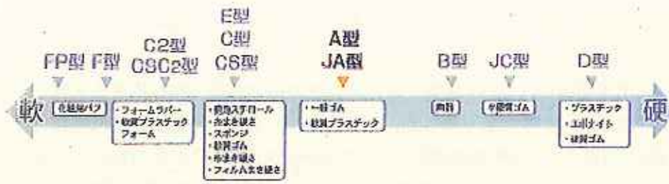
図4 試験材料とデュロメータの型式の簡易的な関係
