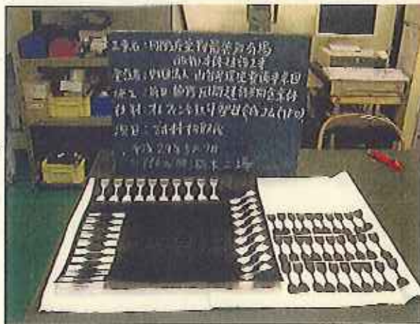
写真1 遮水シートより切り取られた試験片
