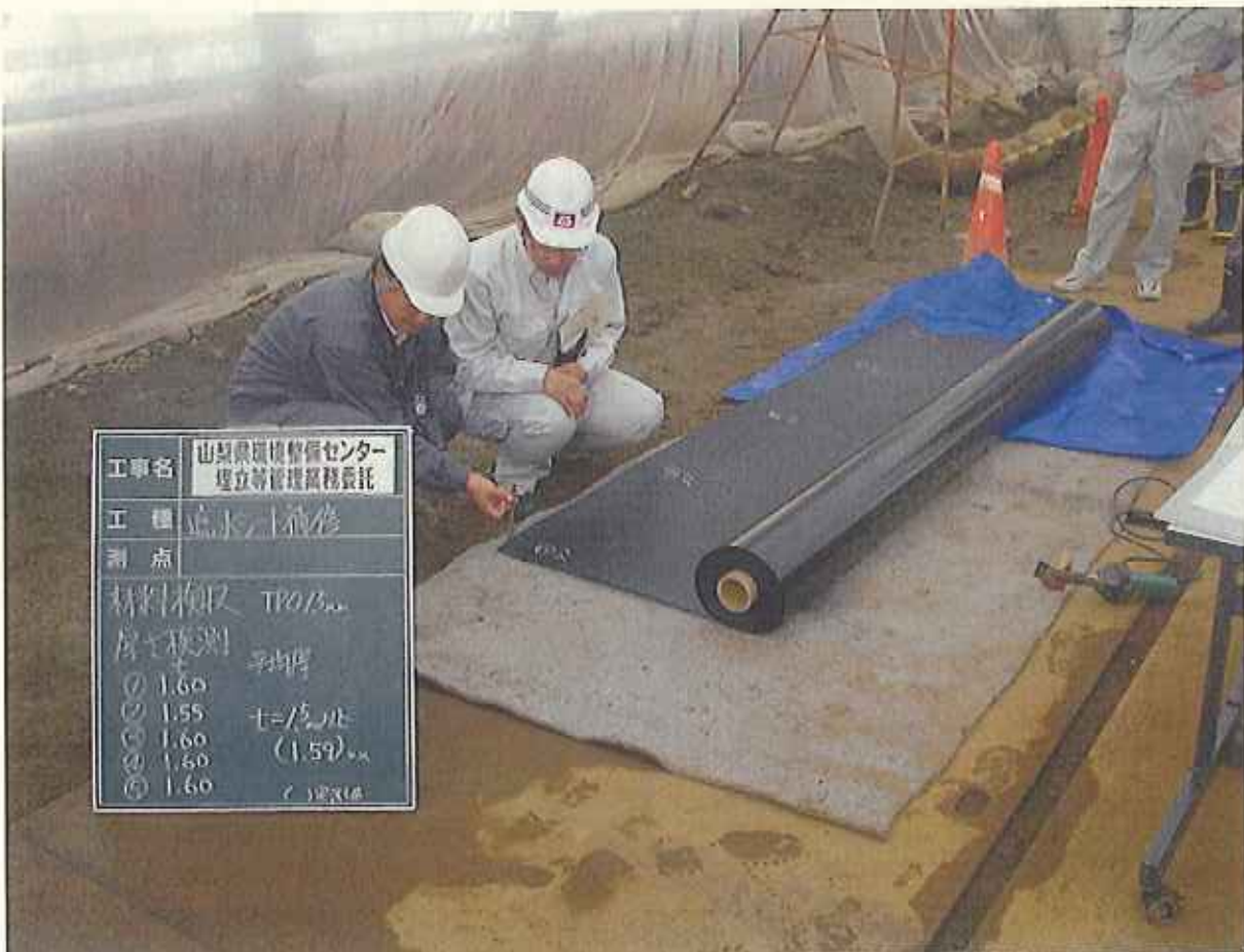
同日(10/19) 修復用遮水シートの厚さを検査 合格(規定値 1.5mm 以上)
