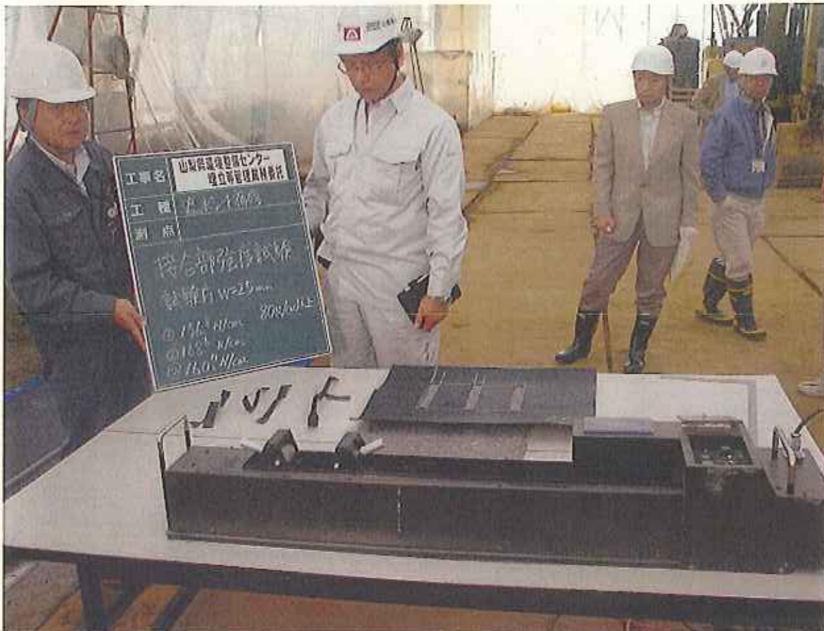
同日(10/19) 遮水シートの熱溶着力(溶着部分の引張検査)を検査 合格(規定値 80N/cm 以上)
